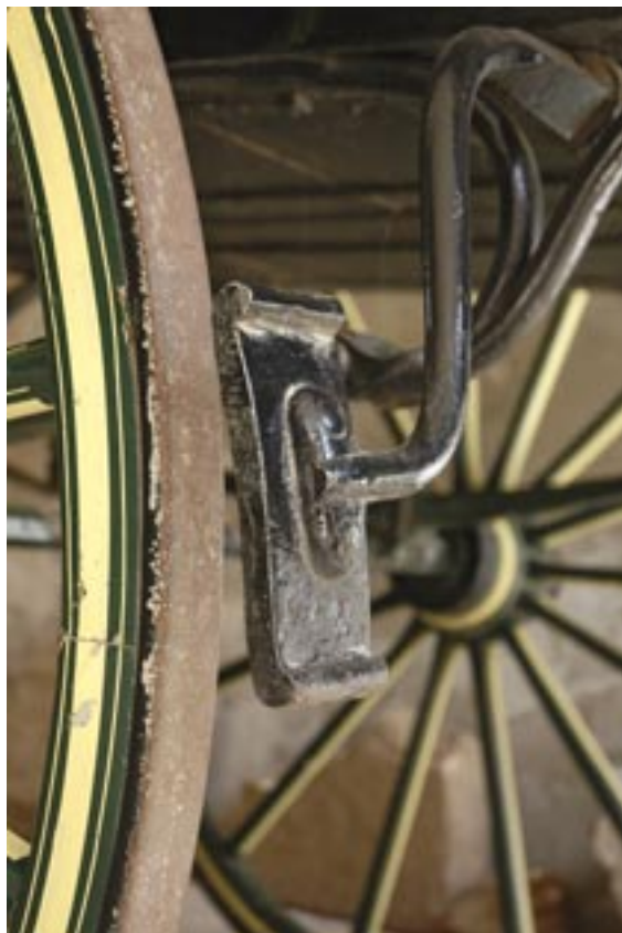
Système de freinage du break d'écurie du château d'Espeyran.
