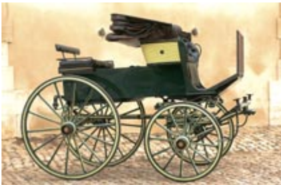
Le mail-phaéton du château d'Espeyran possède une capote à double compas amovible.
