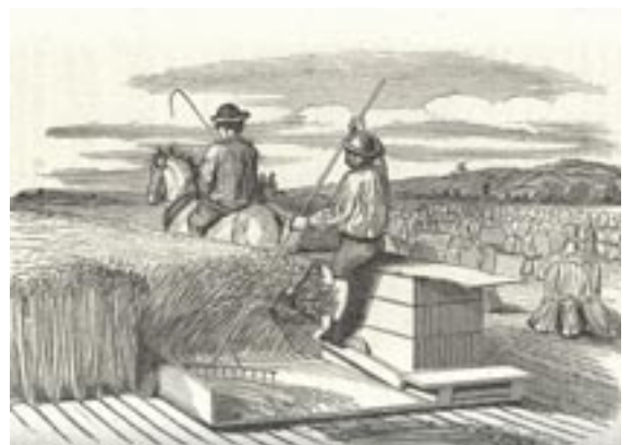
Moissonneuse batteuse fonctionnant avec la force du cheval. A. Jourdier, Le matériel agricole , Paris, Hachette et Cie, 1856.
